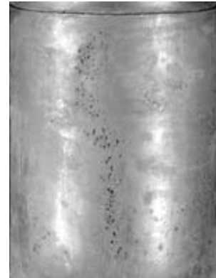
La cavitación crea ondas de choque que arrancan el metal de la bomba dejando las superficies de metales más blandos al descubierto.
